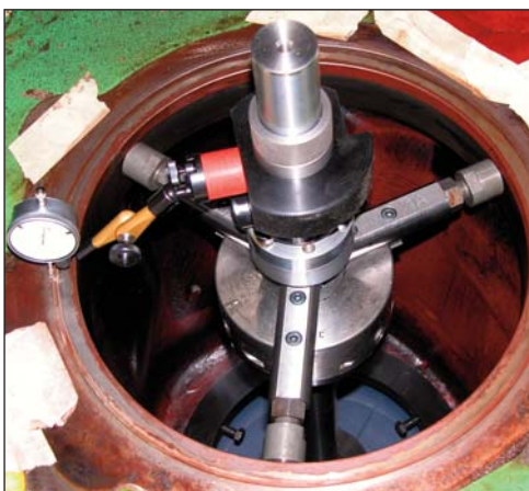
Führungsdorn am Motorblock montiert
